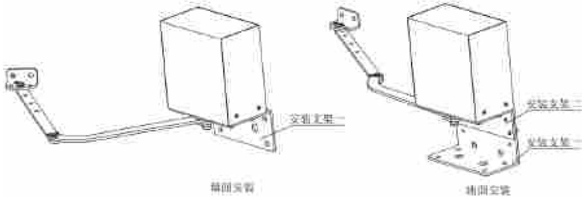
机组挂墙安装时安装支架一与安装支架二拆分开，安装支架一替换安装支架二。
